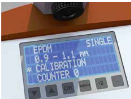
5. Accendere e calibrare lo strumento a induzione Contec.fix SFS Isoweld®3000
