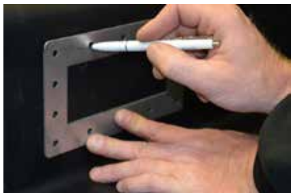
4. Marquez en plein le bord intérieur du profil extrudé (bord précis du trop-plein) et les trous de vis
