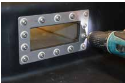
7. Pressprofil montieren Nur mitgelieferte Schrauben mit Dichtungsring verwenden
