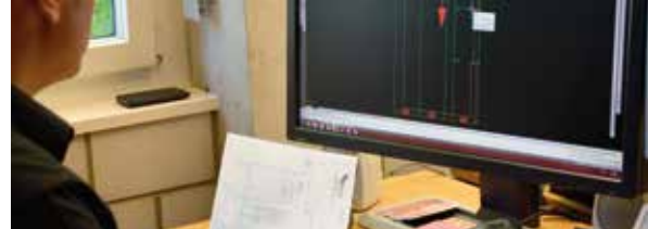
2. CAD-Plan erstellen Die Messdaten werden zu einem CAD-Produktionsplan verarbeitet.
