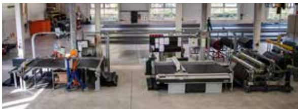
3. Zuschneideanlage schneidet Die CAD-Daten werden an den Cutter übermittelt und alle Teile werden geschnitten, angezeichnet und gestanzt.
